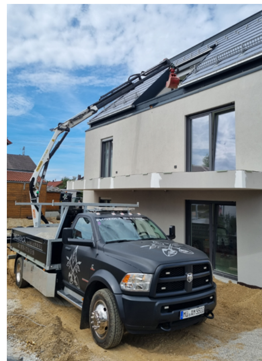
Der Dodge Ram mit 9,5 Tonnen LKW-Zulassung und einem fest verbauten Palfinger Kran auf der Ladefläche kann durch den Ausschub von zwölf Metern auch schwer erreichbare Stellen erreichen.
