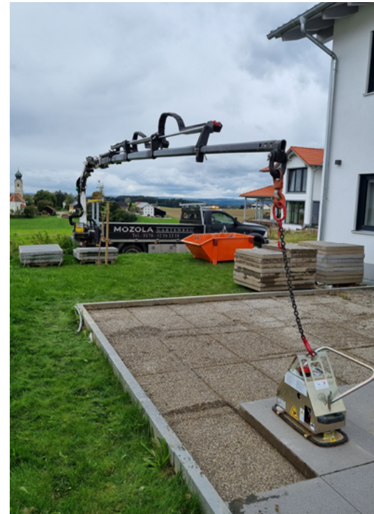
Der Dodge Ram mit 9,5 Tonnen LKW-Zulassung und einem fest verbauten Palfinger Kran auf der Ladefläche kann durch den Ausschub von zwölf Metern auch schwer erreichbare Stellen erreichen.
